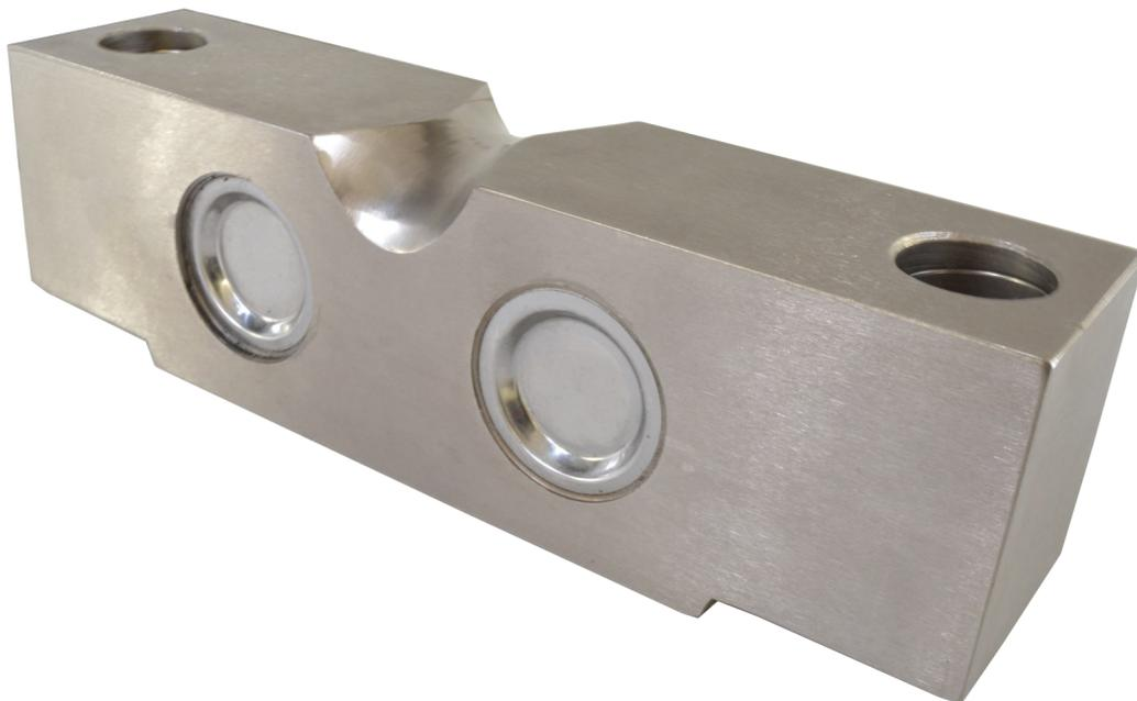
Celda de carga con doble punto de apoyo para basculas camioneras, tolvas, tanques. Clase C3, sensibilidad 3mV/V, fabricada en aleación de acero, protección IP67, Impedancias características 775 ohm entrada y 701 ohm salida. Capacidades disponibles: 50klb, 60klb y 75klb.
