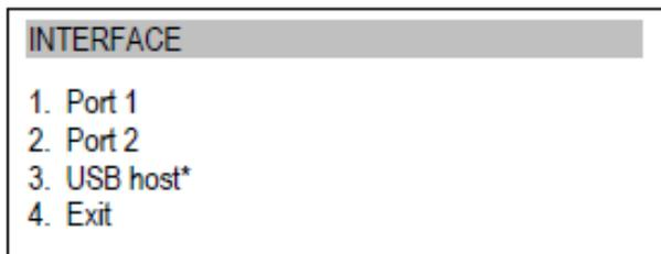
Para configurar los parámetros necesarios, elija la función de interfaz, seleccione el parámetro apropiado y presione tecla→ T ← cuando se muestra la opción requerida o el valor del parámetro. En básculas con un puerto serie adicional, el puerto 1 y el puerto 2 aparecen para la configuración independiente de ambos puertos.
