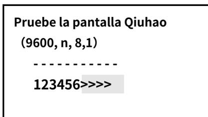
Igual que el método de operación anterior, el instrumento de acuerdo con la velocidad de 9600 baudios, sin calibración, 8 bits de datos, 1 bit de parada, para enviar datos.
