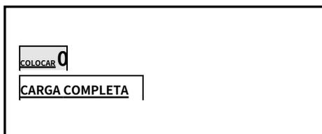
Operación cero: presione la tecla arriba / abajo, seleccione el "cero", la báscula sin peso, ingrese la tecla [OK], el sistema borrará automáticamente el cero, y guarde, regrese al modo de pesaje;
