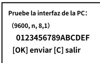
Probador en el estado de recepción en este momento, velocidad de 9600 baudios, sin calibración, 8 bits de datos, 1 bit de parada, y si la computadora a través de una herramienta de depuración de puerto serie para enviar el
