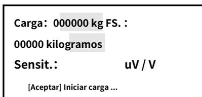
Presione la tecla numérica para poner el peso del valor de carga (puede ingresar su propio peso), presione la tecla arriba / abajo para cambiar al estado de capacidad de entrada, presione la tecla numérica también para ingresar la capacidad del sensor, luego presione [OK] , y comience a cargar el peso (o puede estar en el estrés de la estación al área del sensor), la sensibilidad del instrumento muestra para el sistema que calculó el
