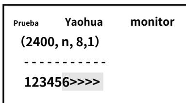
El indicador de acuerdo con la velocidad de 2400 baudios, sin calibración, 8 bits de datos, 1 bit de parada, envía los formatos de comunicación RS232 a la pantalla grande de yaohua y puede ser identificado por la pantalla grande de yaohua, puede ingresar diferentes números para la pantalla grande, si la pantalla es normal, luego juzgue que la pantalla grande es normal, si la pantalla no es normal, para verificar la conexión del cable o juzgar el daño de la pantalla grande
